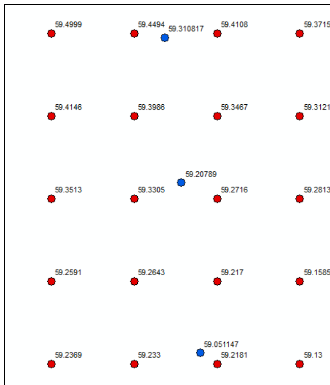
Figura 34 – Punti del Rilievo sovrapposti alla griglia del LIDAR su strada
