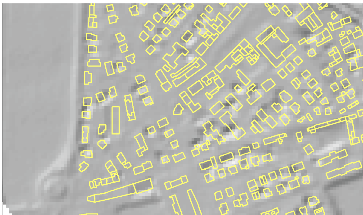
Figura 19 – sovrapposizione DTM con gli edifici riportati nella CTR
