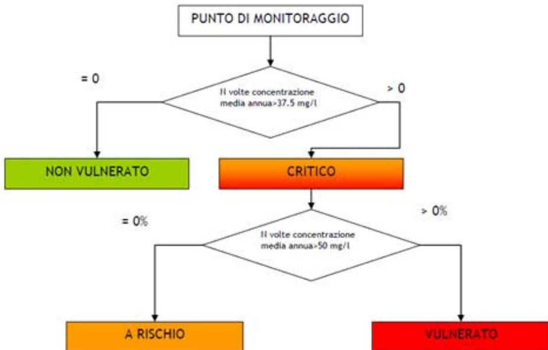
Figura A1. Schema di calcolo del livello di vulnerazione da nitrati di ciascun punto.
