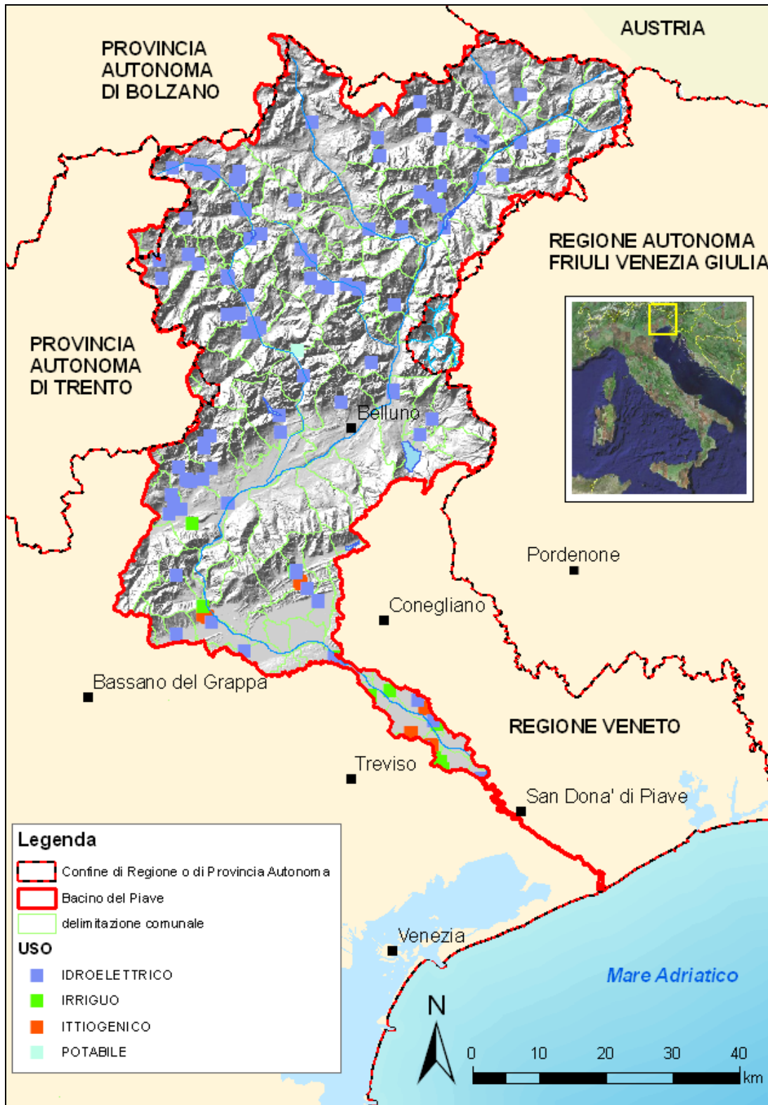
Figura 2.6: indicazione planimetrica delle principali derivazioni superficiali analizzate nel bacino idrografico del fiume Piave.
