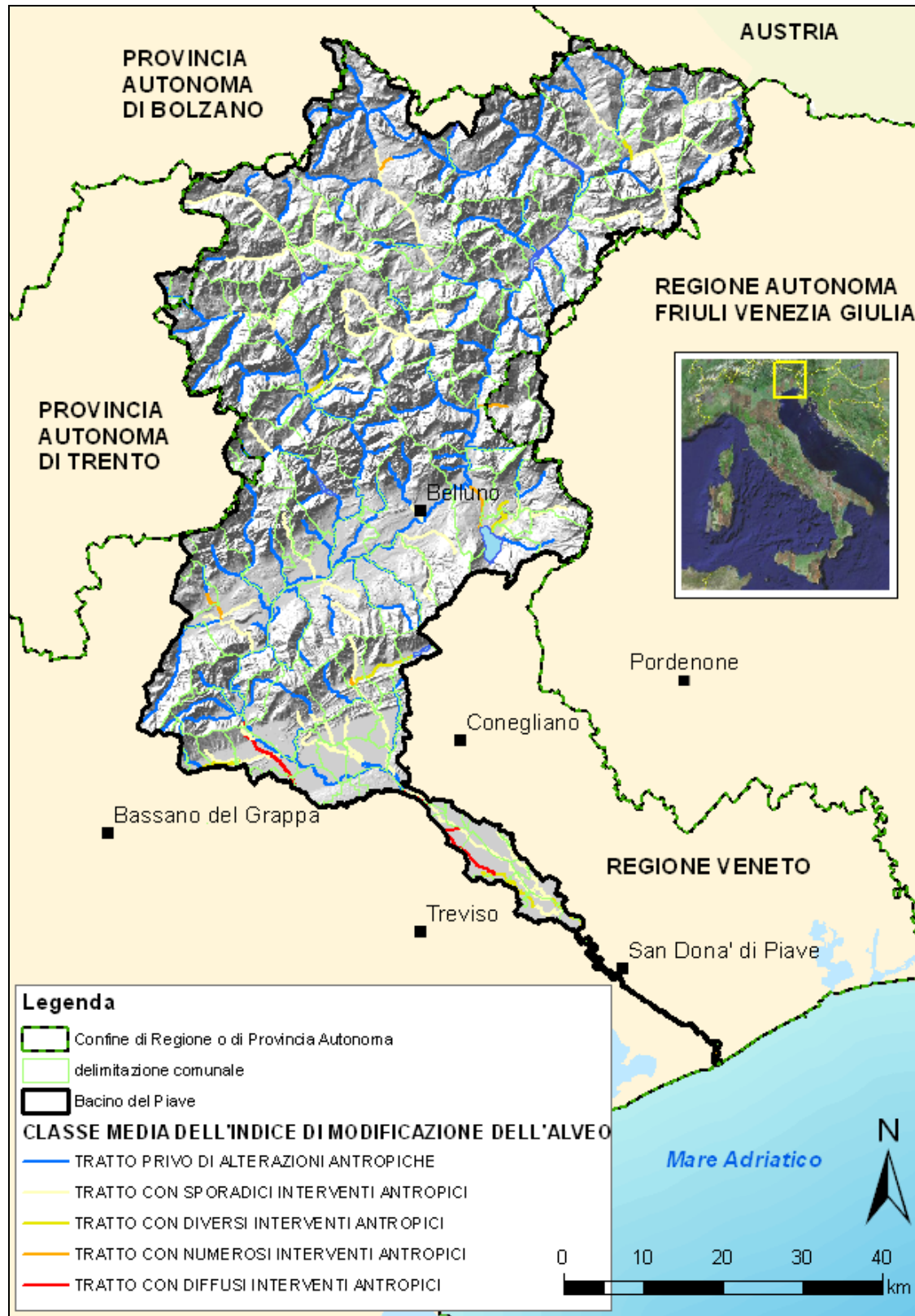
Figura 2.13: carta di sintesi degli impatti idromorfologici, sulla base dei dati della classe media dell'indice di modificazione dell'alveo predisposta provvisoriamente da ARPAV (Parte del bacino del Piave ricadente nella Regione Veneto).
