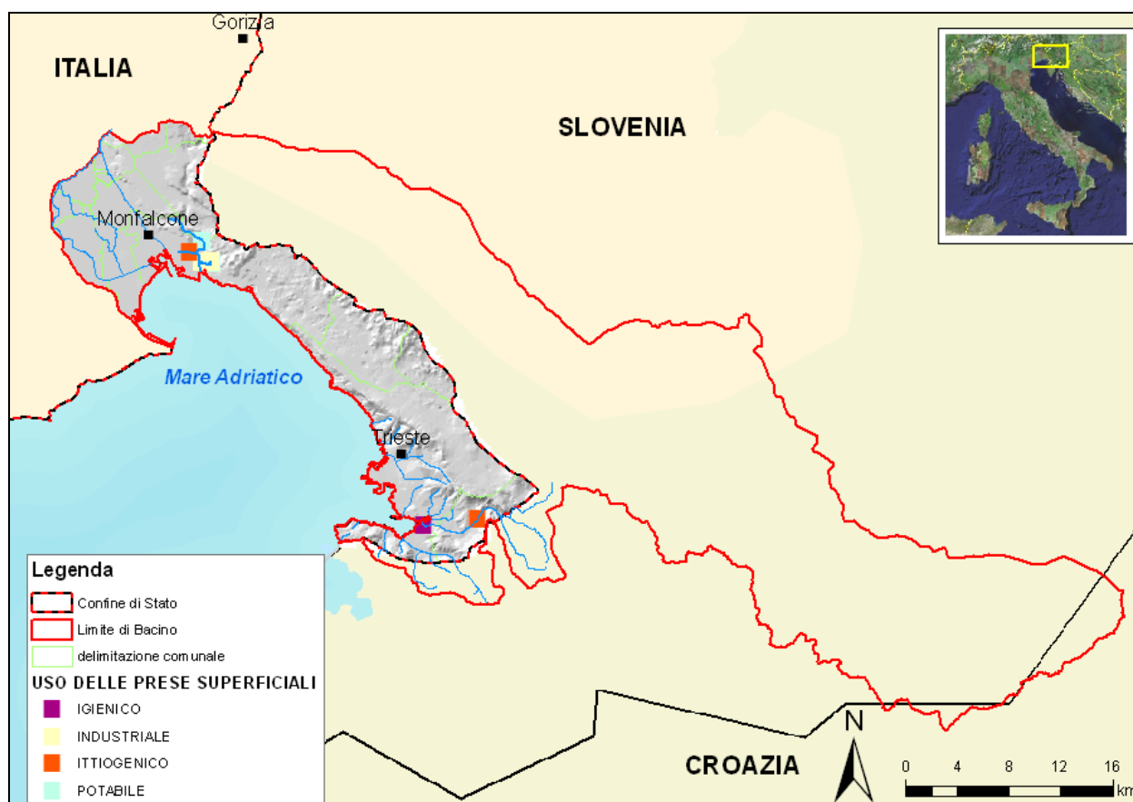
Figura 2.5: indicazione planimetrica delle principali derivazioni superficiali analizzate nel bacino idrografico del Levante.
