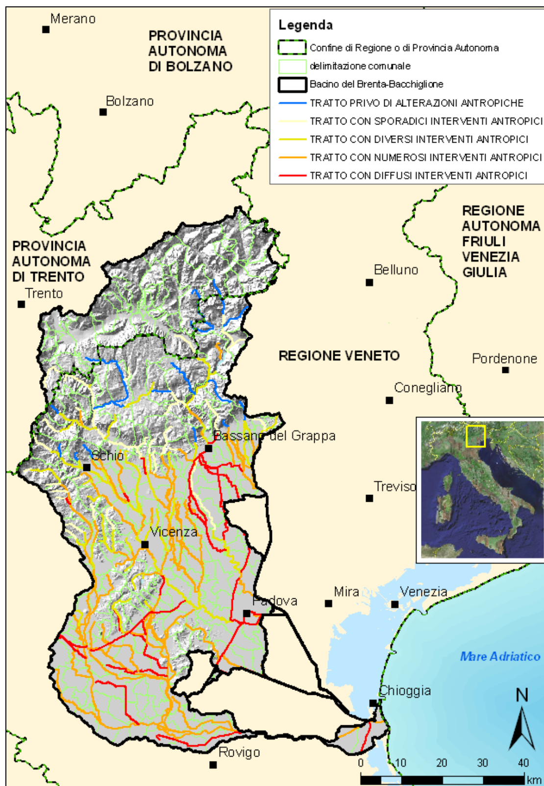
Figura 2.11: carta di sintesi degli impatti idromorfologici, sulla base dei dati della classe media dell'indice di modificazione dell'alveo predisposta provvisoriamente da ARPAV (Parte del bacino del Brenta-Bacchiglione ricadente nella Regione Veneto).
