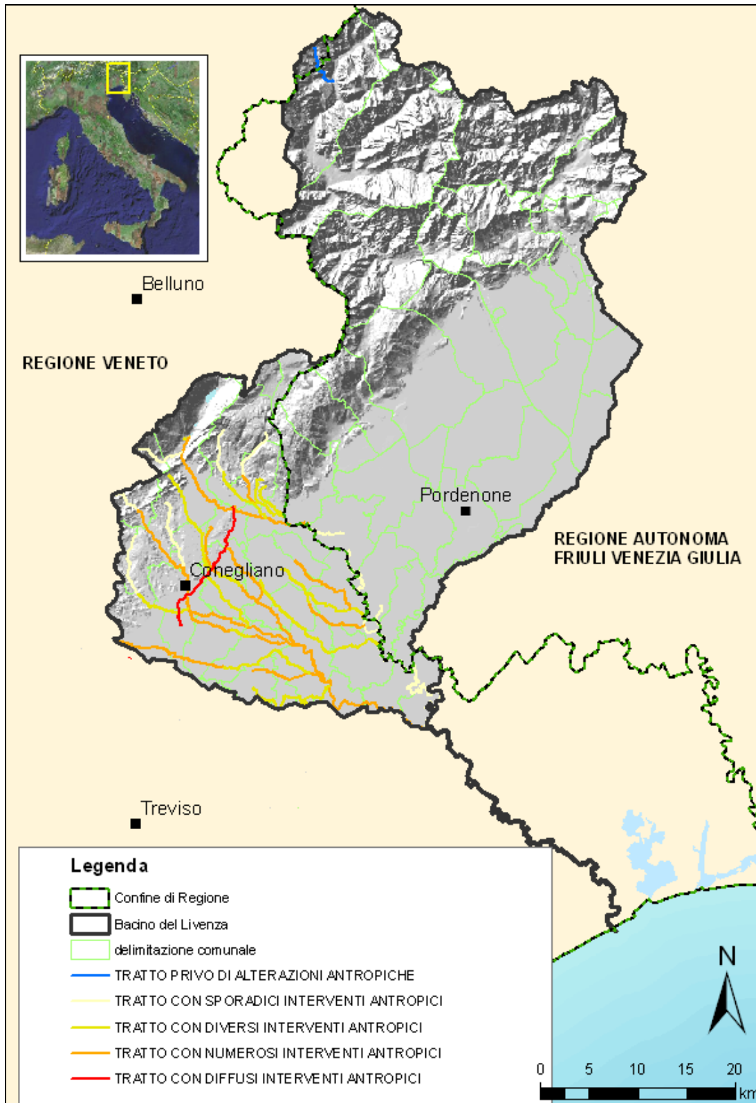
Figura 2.24: carta di sintesi degli impatti idromorfologici, sulla base dei dati della classe media dell'indice di modificazione dell'alveo predisposta provvisoriamente da ARPAV (Parte del bacino del Livenza ricadente nella Regione Veneto).
